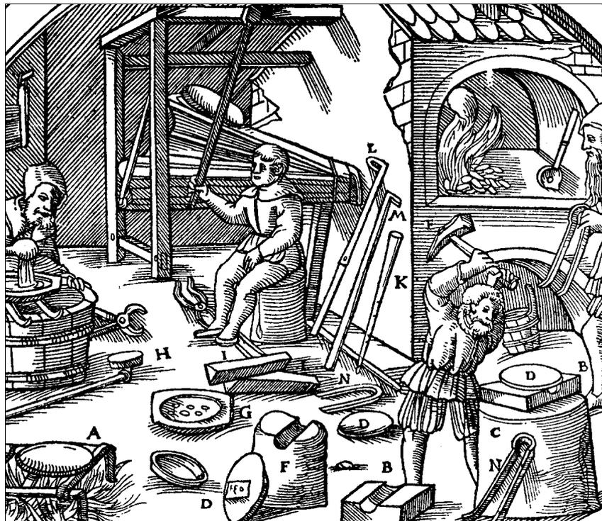
Abb. 4: Vorbereiten und Feinbrennen des Silbers. Der Rost A. Die Messingunterlage B. Der Holzklotz C. Das Silberstück D. Der Hammer E. Der in der Mitte vertiefte Holzklotz F. Der Trog mit Löchern G. Das Rundholz, an einem Eisen befestigt H. Tannenholzscheite I. Die Eisenstange K. Das Gezähe mit Aushöhlung (Probelöffel) L. Das Gezähe mit umgebogenem Ende M. Das Gezähe in Gestalt einer Klemme N. Aus „De re metallica“ von G. Agricola.
