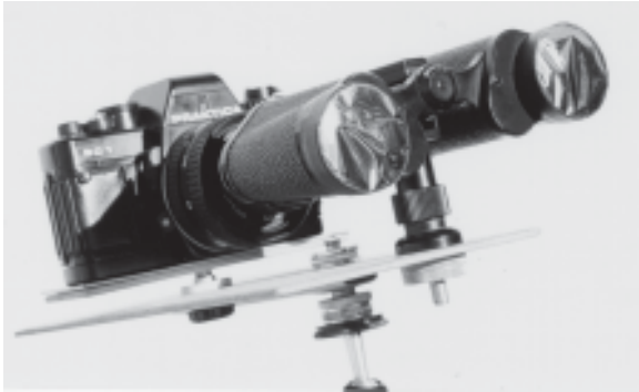
Abb. 4: Anordnung zur Astrofotografie in afokaler Projektion durch ein Fernglas (Foto: K.-H. Lotze).
